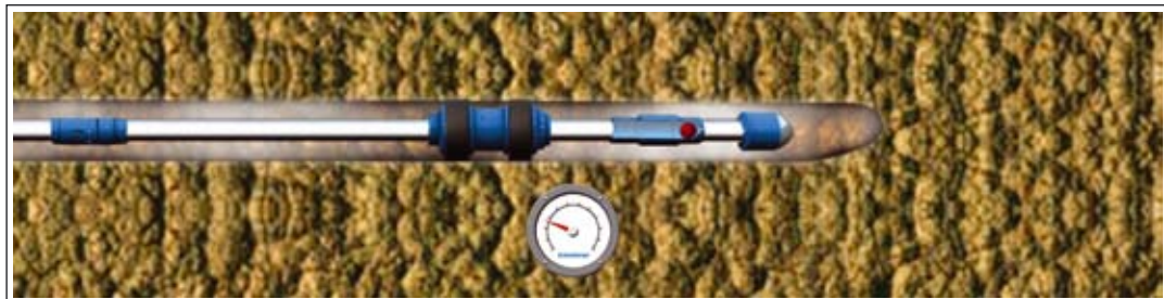
Механический пакер для открытого ствола со сдвоенными уплотняющими элементами для работы под давлением до 68,9 МПа [10.000 psi] и температурой до 218°C [425 degF].
