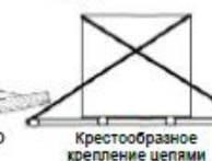
КРЕПЛЕНИЕ МОБИЛЬНОГО ЗДАНИЯ
