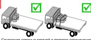
Сочетание стяжных ремней и прямого ограничения с использованием конструкции транспортного средства
