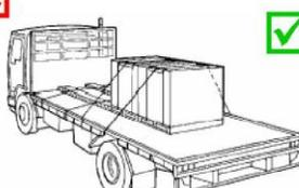
ПОДДОН ПРИЖАТ К ТОРЦУ ГРУЗОВОГО ОТСЕКА
