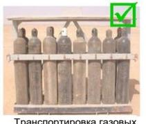
Транспортировка газовых баллонов на стеллажах
