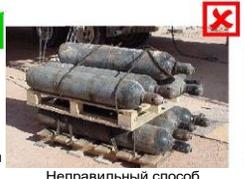
Неправильный способ транспортировки газовых баллонов
