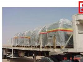
Грузы на поддонах не закреплены и не прижаты к торцу грузового отсека
